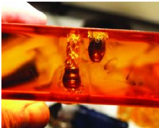
Слика 4.2: Полидидиклопентадиенска смола која зауставља метке од 9 мм
